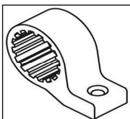
Abb. 20 - Flexible Gummiklemme
